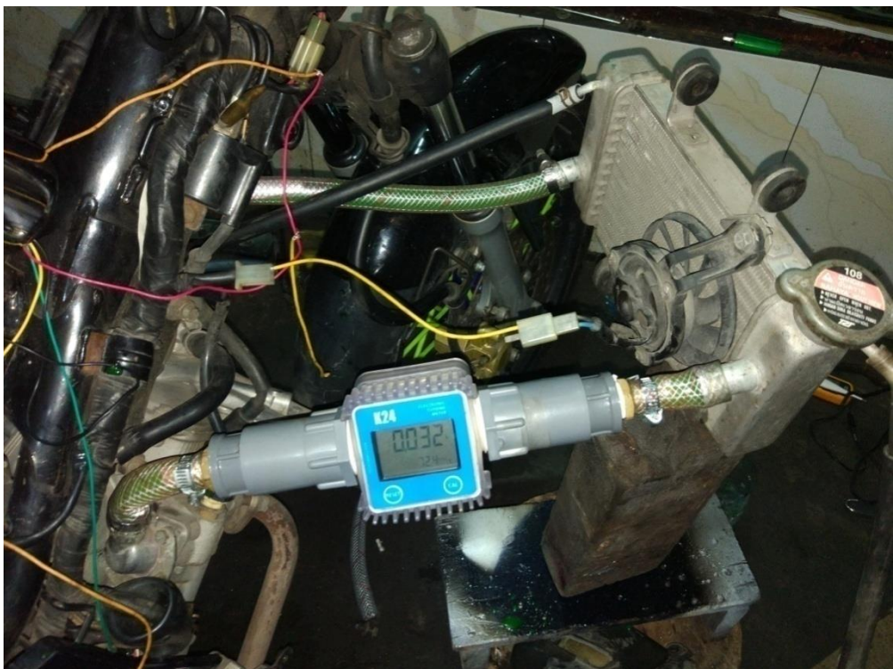
Gambar Pengujian Pada Radiator
