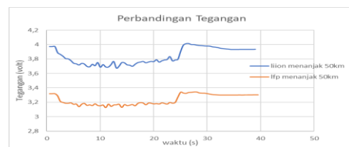
Gambar 4. 11 Perbandingan tegangan jalur menanjak kecepatan 50km/jam
