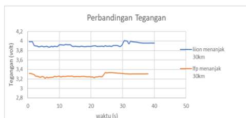
Gambar 4. 9 Perbandingan tegangan jalur menanjak kecepatan 30km/jam
