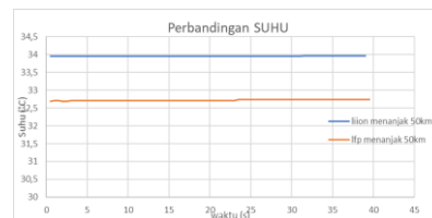
Gambar 4. 12 Perbandingan suhu jalur menanjak kecepatan 50km/jam
