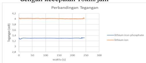
Gambar 4. 2 Perbandingan tegangan jalur mendatar kecepatan 10km/jam
