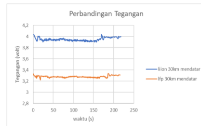
Gambar 4. 4 Perbandingan tegangan jalur mendatar kecepatan 30km/jam
