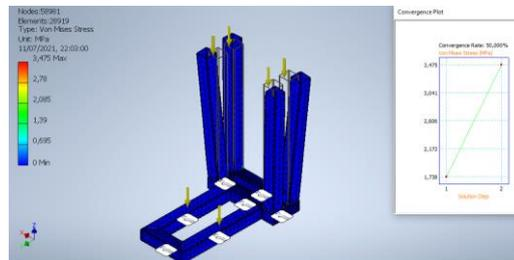
Gambar 7 pengujian kedua Von Mises Stress
