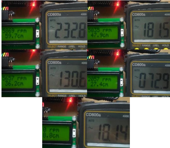
Gambar 4.7 Output trafo pada kecepatan 4, 3, 2, dan 1
