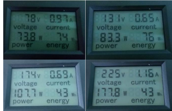
Gambar 4.12 Pengukuran daya pada kecepatan 1, 2, 3 dan 4
