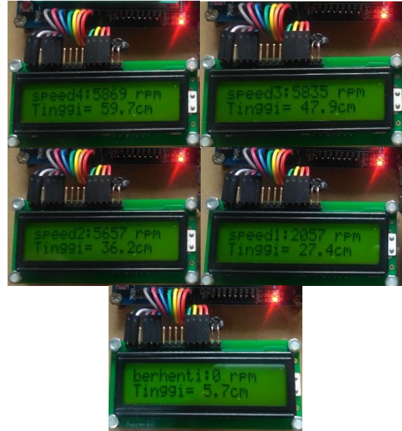
Gambar 4.2 Pengujian kecepatan pompa pada ketinggian 60-50cm, 50-40cm, 40-30cm, 30-20cm, 20-0cm
