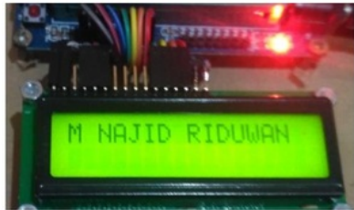
Gambar 4.1 Pengujian rangkaian LCD
