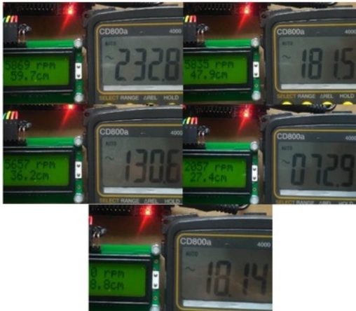
Gambar 4.7 Output trafo pada kecepatan 4, 3, 2, dan 1
