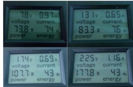
Gambar 4.12 Pengukuran daya pada kecepatan 1, 2, 3 dan 4
