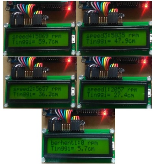
Gambar 4.2 Pengujian kecepatan pompa pada ketinggian 60-50cm, 50-40cm, 40-30cm, 30-20cm, 20-0cm
