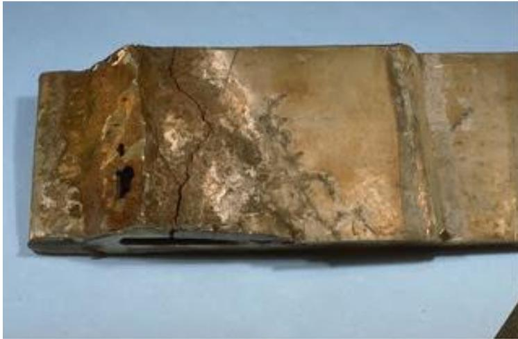
*Gambar 2.14 : korosi SCC pada sebuah logam*
