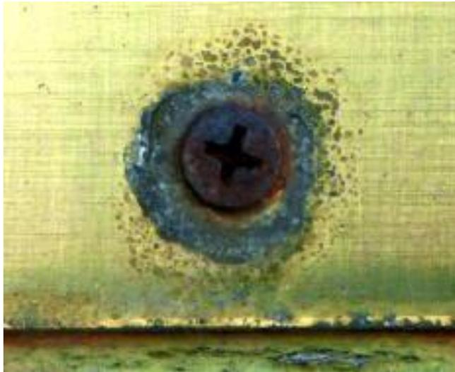
*Gambar 2.4 : Korosi Galvanic pada Sambungan Baut*
