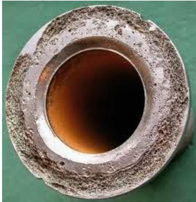
*Gambar 2.8 : korosi celah pada sambungan pipa*
