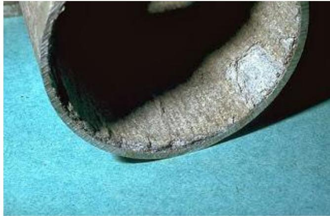
Gambar 2.12 : korosi batas butir pada pipa
