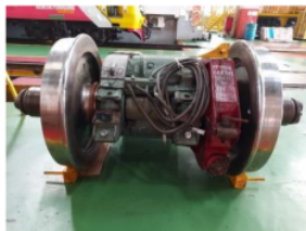
Gambar 2.1 GE 761 Traksi Motor
