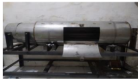
Gambar 8 kerangka pengering biji kopi
