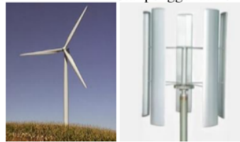
Gambar 1 PLTA dengan kincir berporos horizontal dan vertikal
