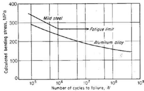
Gambar 4. Batas leleh logam ferrous dan non-ferrous
