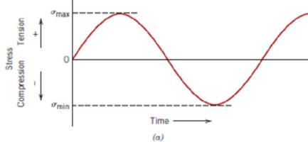
Gambar 5. Notasi untuk beban siklus amplitudo konstan
