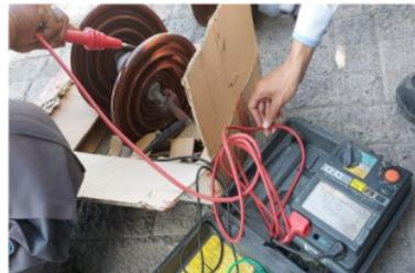
Gambar 4. 4 Proses Uji Tahanan Isolasi
