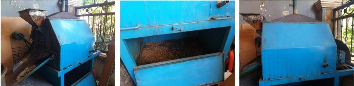
Alat tersebut digunakan oleh UMKM MMCoffee. Kekurangan dari alat roasting kopi tersebut adalah pengecekan suhu dari drum masih manual, masih menggunakan kompor gas yang mana panas dari api kompor yang dihasilkan sulit untuk stabil, tidak mudah untuk dipindahkan, pengatur suhu dan waktu dari mesin roasting masih manual, dan kopi dengan tingkat kecacatan jumlahnya banyak.
