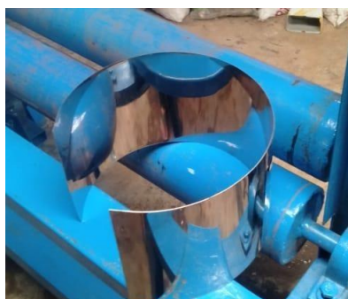
Gambar 1.2 Output Mesin Roll Plat Lama
