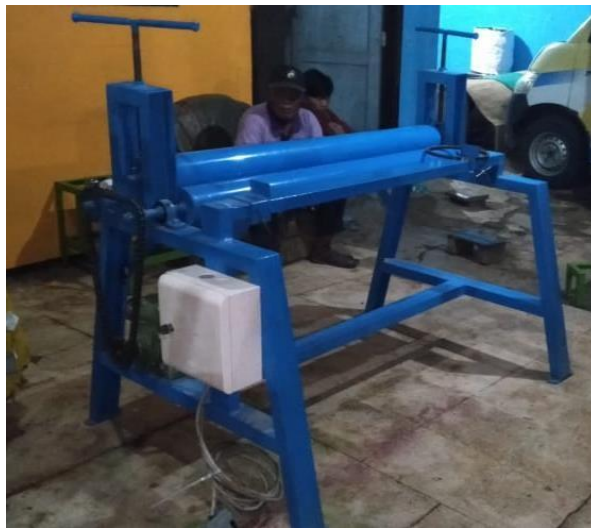
Gambar 1.1 Mesin Roll Plat Baru
