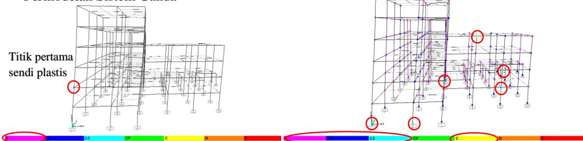
Gambar 7. Keruntuhan Step 1 sampai 16 pada Sistem Ganda Arah X
