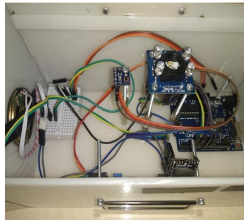
Gambar 3.1 Hasil perancangan alat pendeteksi nilai uan kertas untuk penyandang tunanetra.
