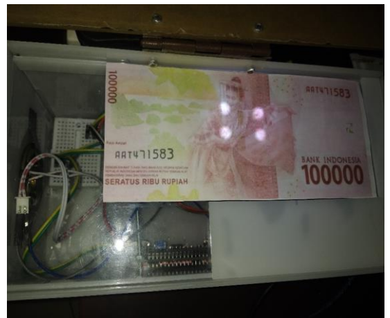
Gambar 4.24 Pengujian terhadap uang kertas palsu Rp.100.000
