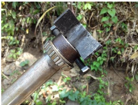
Gambar 17. Bearing dan Shaft Penghubung Generator
