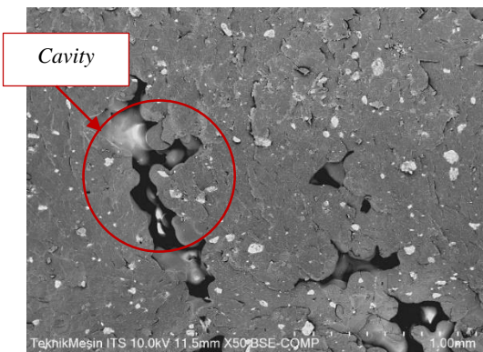
Gambar 10.(b) Hasil uji SEM mesh 200-250 waktu tahan 0 menit perbesaran 50x (uji bending)
