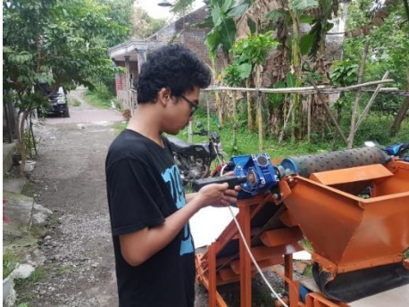
Mengukur RPM pada motor listrik
