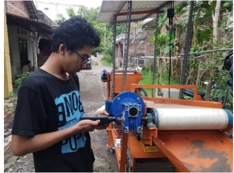
Mengukur RPM pada motor listrik
