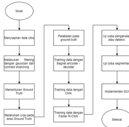
Gambar 1. Tahapan Penelitian Deteksi Kerusakan Pada Permukaan Material
