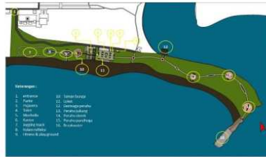
Gambar 2. pola tatanan masa Pola tatanan massa ini berupa bangunan banyak masa dimana penataannya berupa linear mengikuti bentuk panjang jalan yang ada.
