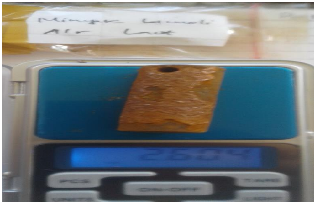
Gambar 20. Berat akhir Minyak Bimoli dengan direndam Air Laut
