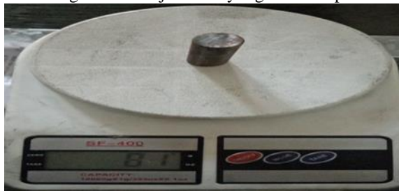
Gambar 7. Timbangan awal baja ST 41 yang akan dilapisi Resin
