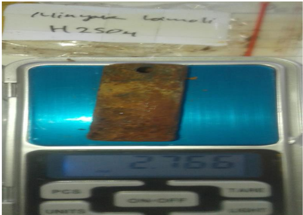
Gambar 21. Berat akhir Minyak Bimoli direndam dengan larutan H 2 SO 4
