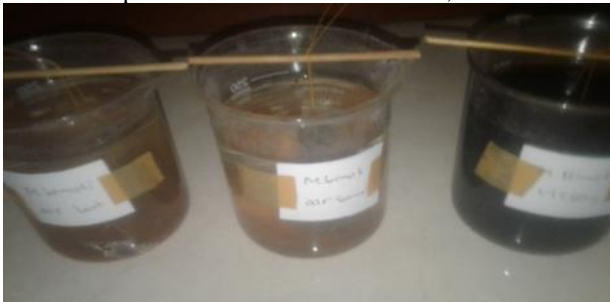
Gambar 14. Pelapisan Minyak Bimoli direndam Air Laut,Air Sumur dan H 2 SO 4
