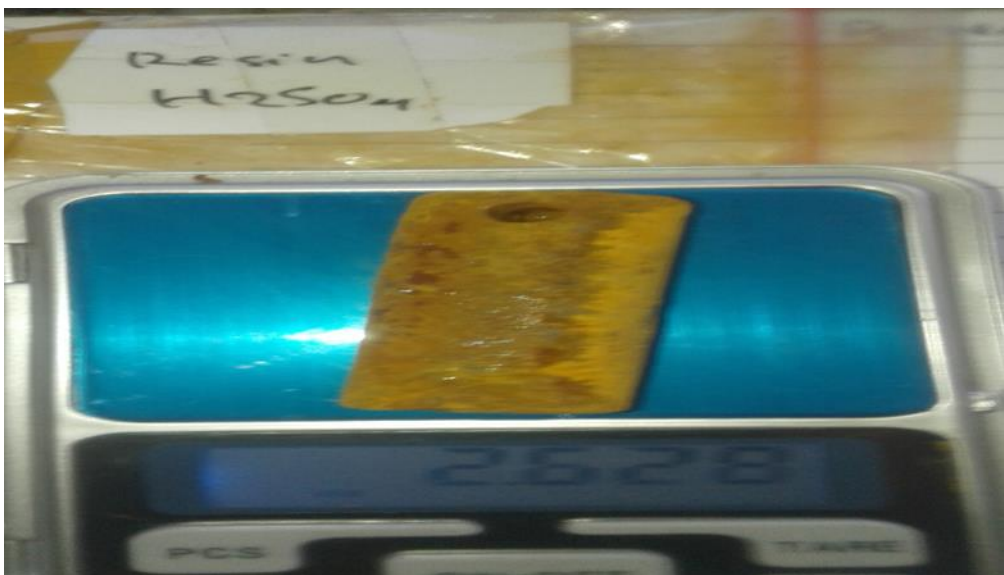
Gambar 24. Berat akhir Resin direndam dengan larutan H 2 SO 4
