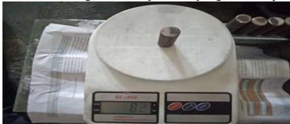
Gambar 2. Timbangan awal baja ST 41 yang akan dilapisi Oli
