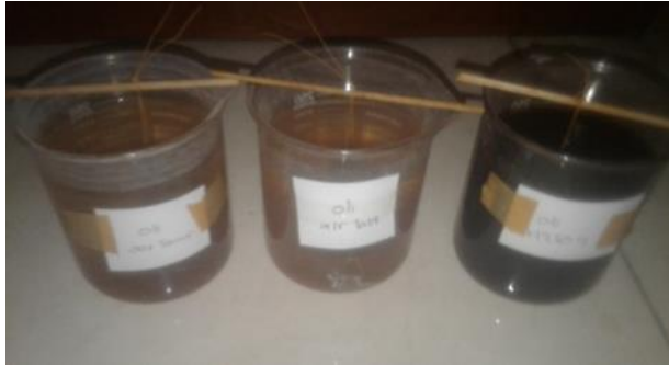
Gambar 13. Pelapisan Oli direndam Air Sumur,Air Laut dan H 2 SO 4
