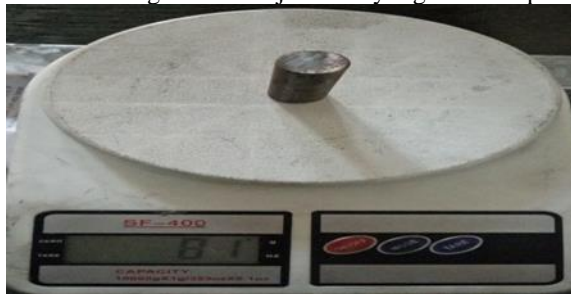
Gambar 8. Timbangan awal baja ST 41 yang akan dilapisi Resin
