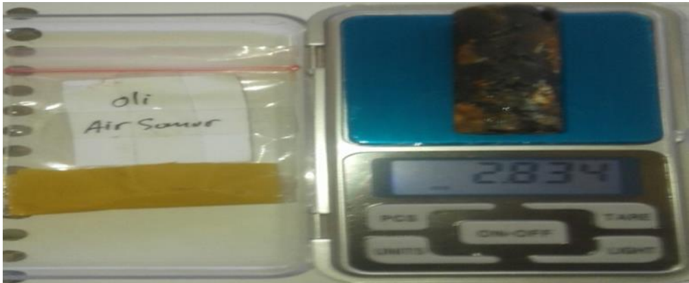
Gambar 16. Berat akhir lapisan Oli direndam dengan air sumur
