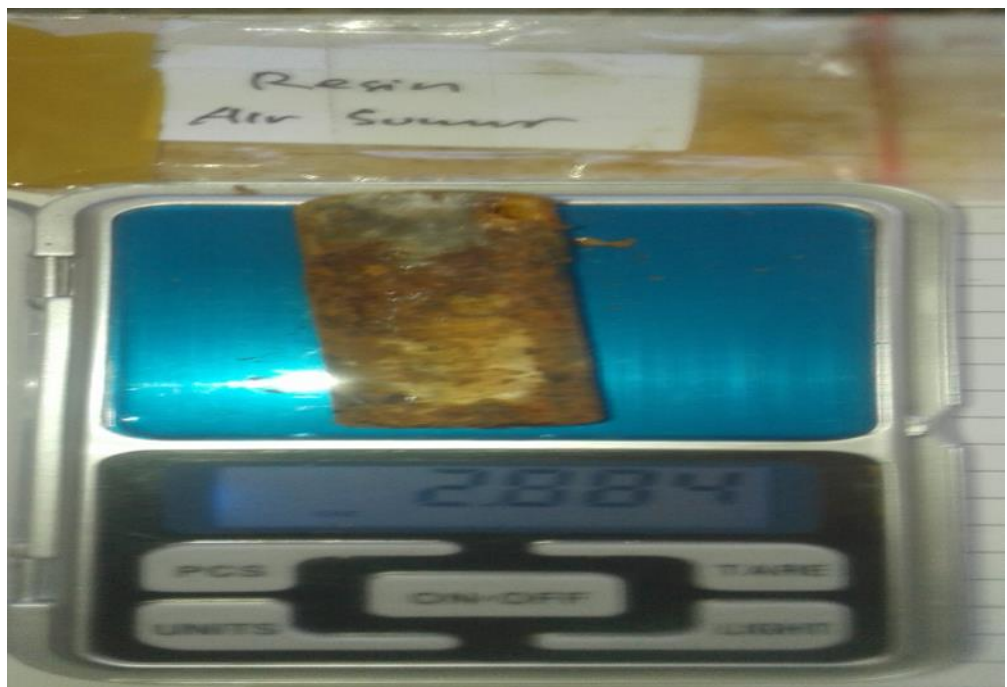
Gambar 22. Berat akhir Resin direndam dengan Air Sumur
