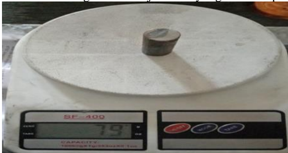
Gambar 3. Timbangan awal baja yang akan dilapisi Oli
