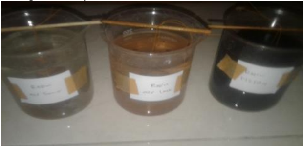
Gambar 14. Pelapisan Minyak Bimoli direndam Air Laut,Air Sumur dan H 2 SO 4
