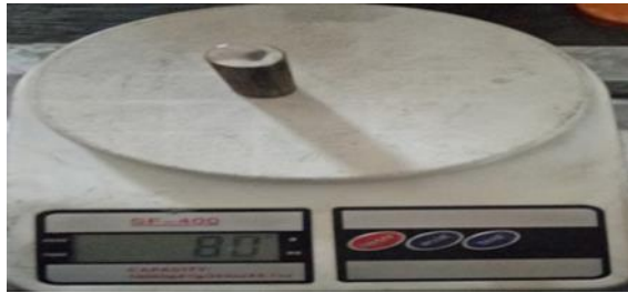
Gambar 1. Timbangan awal baja ST 41 yang akan dilapisi Oli
