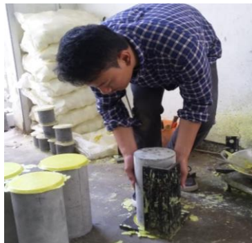
Proses Capping pada alas beton
