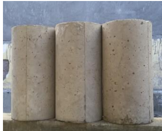
Beton setelah dilepas dari cetakan
