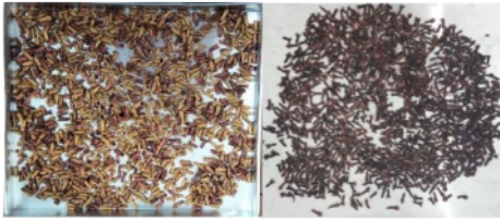
Gambar 3 Perbedaan Warna Cengkeh Sebelum dan Setelah Dikeringkan Selama 5 Jam dengan Kecepatan Udara 5 m/s dan Tray Datar
