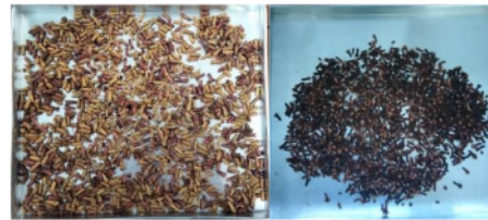
Gambar 1 Perbedaan Warna Cengkeh Sebelum dan Sesudah Dikeringkan Selama 5 Jam dengan Kecepatan Udara 4 m/s dan Tray Datar
