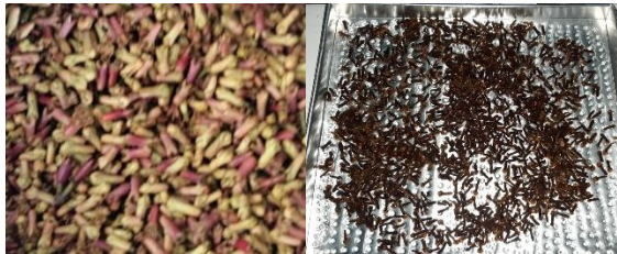
Gambar 5 Perbedaan Warna Cengkeh Sebelum dan Sesudah Dikeringkan Selama 4 Jam dengan Kecepatan Udara 4 m/s dan Tray Berlubang
