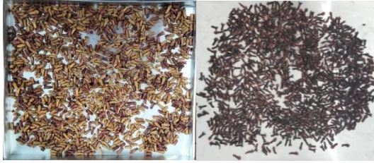
Gambar 3 Perbedaan Warna Cengkeh Sebelum dan Sesudah Dikeringkan Selama 5 Jam dengan Kecepatan Udara 5 m/s dan Tray Datar
