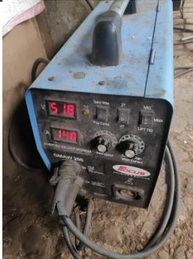
Proses pemanasan baja st 60 dengan menggunakan variasi arus 140
