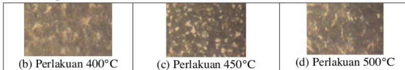
Gambar 3. Struktur Mikro Baja ST 60 Daerah Heat Affected Zone (HAZ)
