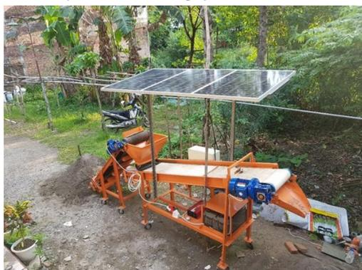
Gambar 4.1 Peletakan Komponen PLTS
