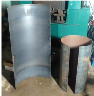
Gambar 4.11 Hasil Uji Coba Mesin Roll Plat
