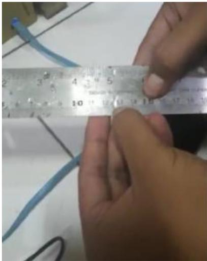
Setelah didapat pengukuran tinggi air secara real atau manual akan di cocokan dengan data yang sensor dapat
