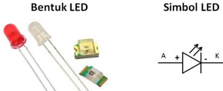
Gambar 2. 1 simbol dan bentuk LED
