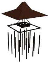
Gambar 4. Struktur bangunan joglo (Sumber: Data penulis)
