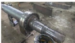
Gambar 5. Bearing yang sudah di Maintenance
