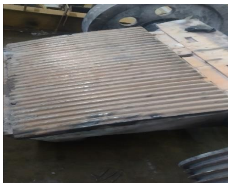
Gambar 6. Gigi Jaw crusher atau Hammer Crusher
