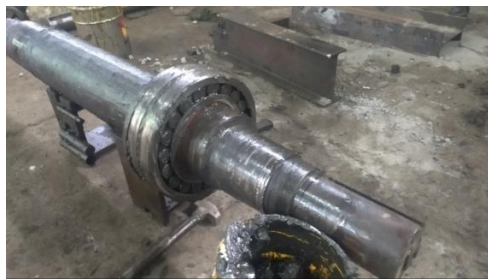
Gambar 5. Bearing yang sudah di Maintenance
