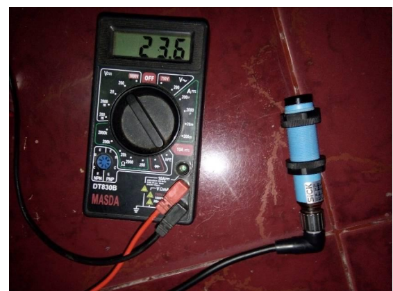
Gambar 4.2 Pengukuran tegangan sensor photoelektrik tipe SICK
