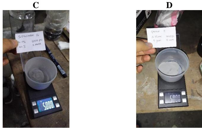
**Keterangan :** A.B. Proses pengadukan dengan metode *dry mixing*, C.D. Proses penimbangan bahan sebelum di cetak dengan massa 5gram.
