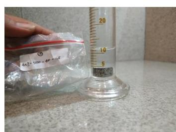
**Keterangan :** A. Menyiapkan alat dan bahan B. Waterpass untuk mencari lokasi yang merata untuk tempat timbangan. C. Penimbangan spesimen untuk massa awal. D. Mengukur massa air dengan volume skala 10 ml E. Spesimen dimasukkan ke dalam air aquades
