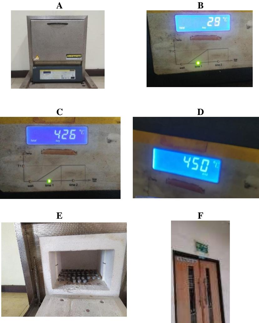
**Keterangan :** A. Alat perlakuan panas (*furnace*). B. Melakukan setting waktu tahan Sintering dengan Waktu Tahan Sintering 60,90,120 menit. C. Melakukan setting Suhu Temperatur  $400^{\circ}\text{C}$ ,  $450^{\circ}\text{C}$ , dan  $500^{\circ}\text{C}$ . D. Suhu Temperatur  $450^{\circ}\text{C}$ . E. Spesimen setelah mendapat perlakuan panas. F. Dokumentasi tempat laboratorium.
