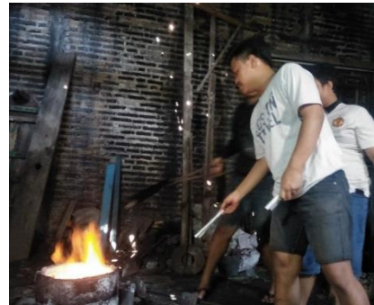
Proses Pemasukan Material ke dalam Tungku Cor
