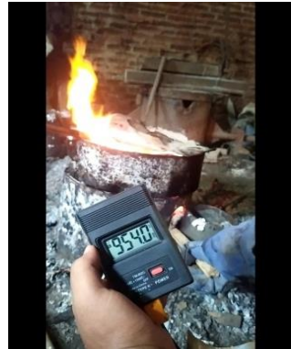
Proses pengangkatan dari suhu 950 derajat
