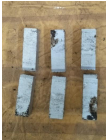
Setelah pengujian impact charpy
