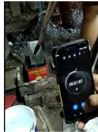
Setelah masuk cetakan waktu tahan 5 menit
