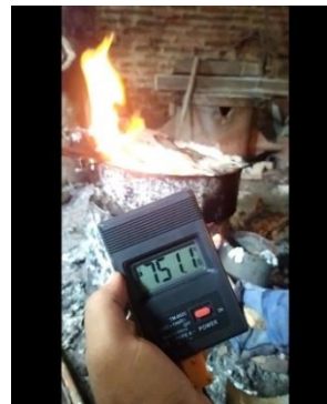
Proses pengangkatan dari suhu lebur 750 derajat
