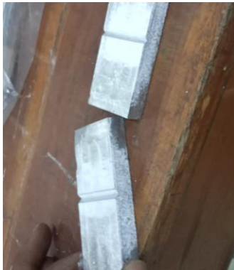
Proses pengerjaan material dibentuk sesuai benda uji
