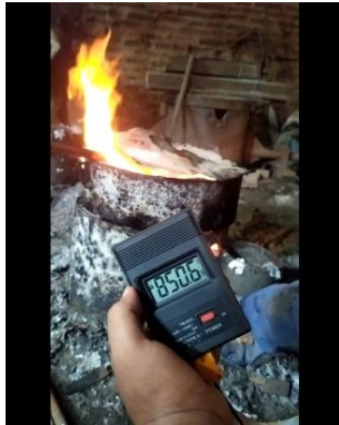
Proses pengangkatan dari suhu 850 derajat
