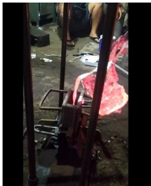
Proses Penuangan ke cetakan
