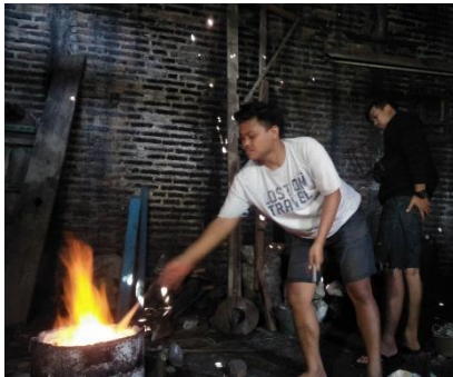
Proses Pemasukan Material ke dalam Tungku Cor
